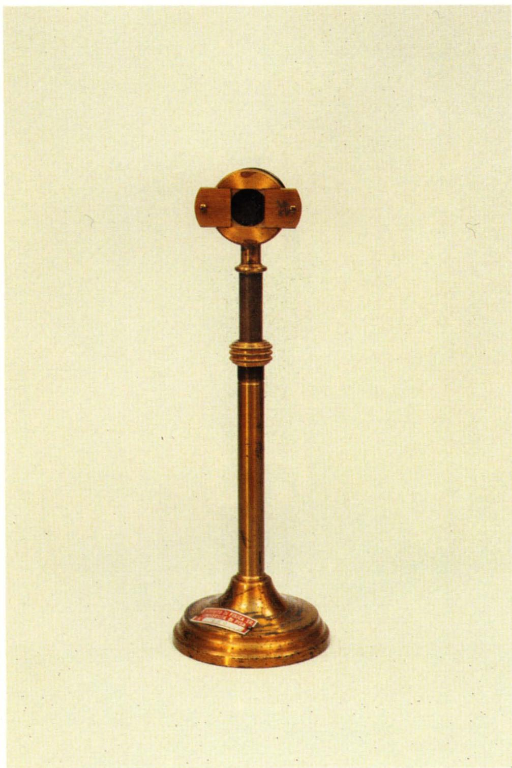
*Pila termoelettrica per l'analisi dello spettro
